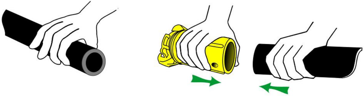
Corte a extremidade da mangueira de forma limpa, para uma melhor vedação entre a extremidade da mangueira e a face da flange do acoplamento. Fugas e danos no acoplamento podem ocorrer se a mangueira não encaixar perfeitamente no topo do acoplamento.
