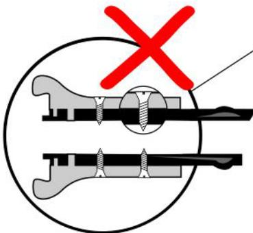
Nas furações disponíveis utilizar os parafusos adequados para segurar a mangueira ao acoplamento. Durante a instalação, os parafusos vão agarrar a mangueira e criar uma vedação contra o acoplamento à medida que este é apertado.
