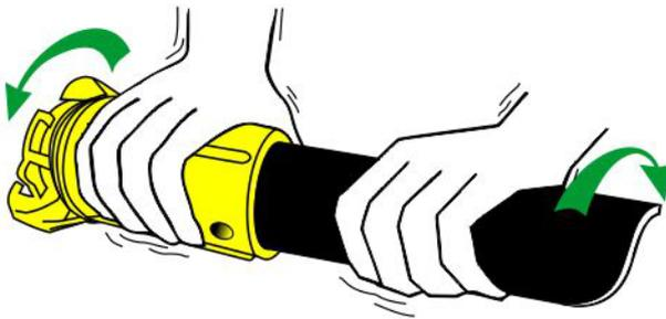
Rodar a mangueira no sentido apropriado ao acoplamento até ficar firmemente encostada à face da flange do acoplamento.
