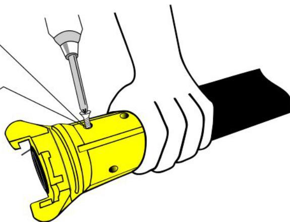
Não aperte excessivamente e não utilize parafusos demasiado longos. A perfuração da camada interna da mangueira criará um desgaste acelerado e bolsas de infiltração no interior da mangueira.
